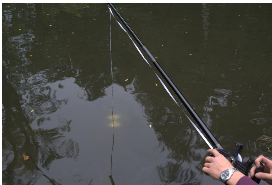
Rysunek 4 Pomiar krążkiem secchiego zbiornik Z1 25.09.2015
